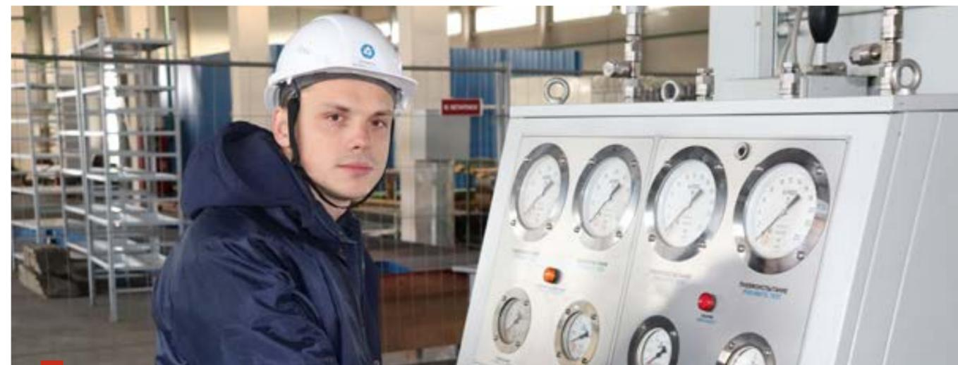
Выполнение настройки предохранительных клапанов на испытательном стенде. Гиргель И.Ю., ТР ПНР по ГПМ Представительства АТЭ в Республике Беларусь
